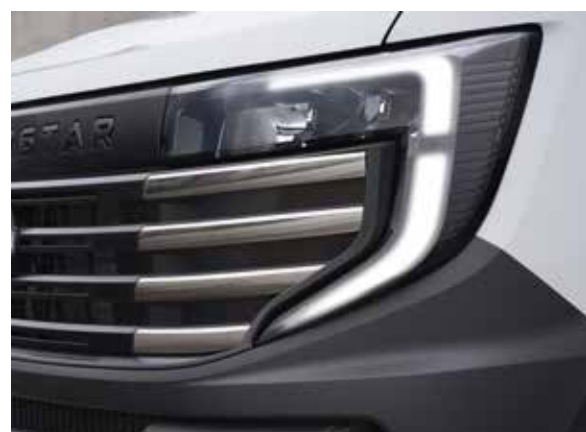
Fari anteriori e posteriori Full LED e luci diurne LED di serie
